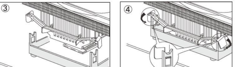
コア接触面がCPUのコア部分と平行になるように載せて下さい。
