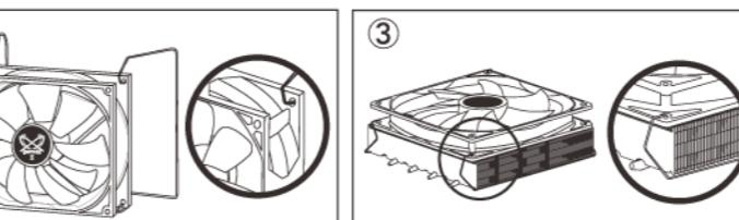
120mmファンに、付属の120mmファン装着用クリップの留め具部分を本体の切り込み部分に掛けてファンをしっかりと固定して下さい。留め具部分が切り込み部分にしっかりと固定されてしませんとファンが外れる可能性がありますのでご注意下さい。
