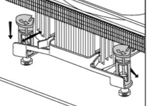
コア接触面がCPUのコア部分と平行になるように載せて下さい。
