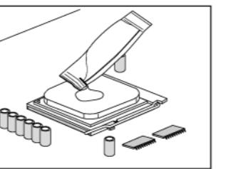
クーラー本体底面(コア接触面)の保護シートを引き剥がし、図のようにLGA用取り付け金具をクーラー本体にカチリというまで奥に完全に押し込み取り付けます。
