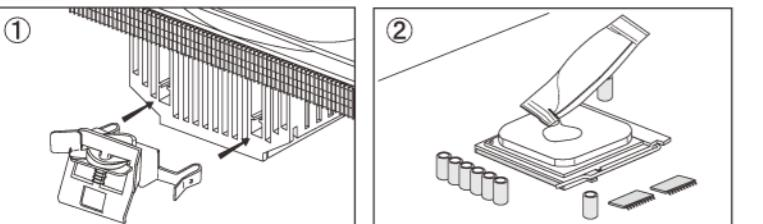
クーラー本体底面(コア接触面)の保護シートを引き剥がし、図のようにSocket 754,939,940,AM2,AM2+,AM3用取り付け金具をクーラー本体にカナリといまで奥に完全に押し込み取り付けます。
