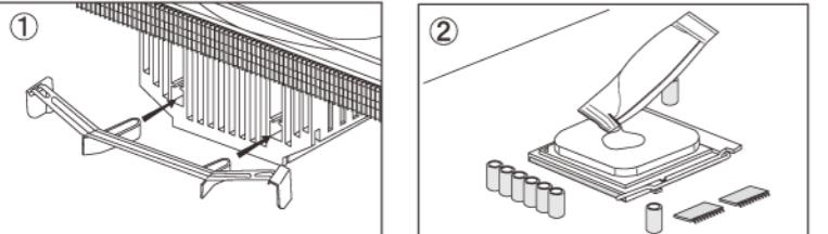
クーラー本体底面(コア接触面)の保護シートを引き剥がし、図のようにSocket 478取り付け金具をクーラー本体にカナリといまで奥に完全に押し込み取り付けます。
